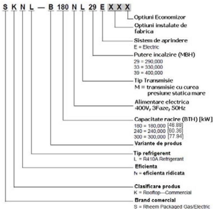
Codurile opțiunilor instalate de fabrică pentru modelele SKNL-B 180/240/300
