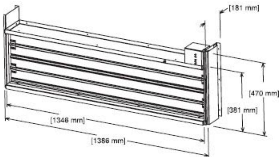
RXRF-KF1 - clapeta actionată manual pentru admisie aer proaspăt
