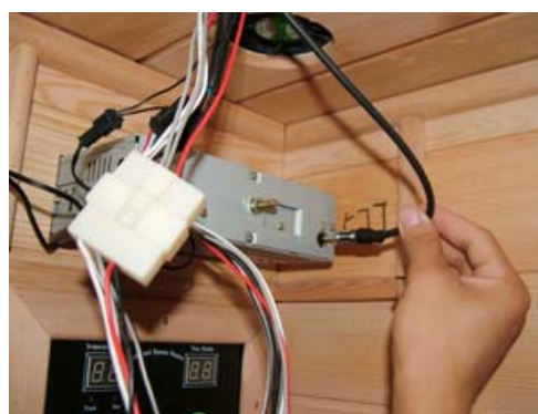
FIG-21 Ligue os fios da antena
