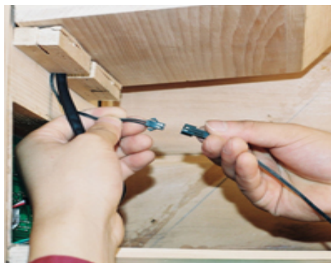
FIG-19 Conecte el cable del sensor
