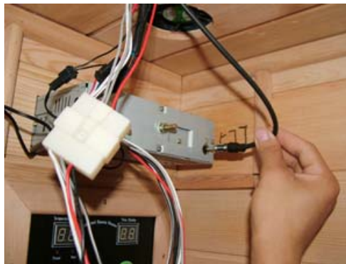
FIG-21 Conecte el cable de la antena
