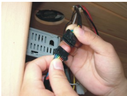
FIG-20 Conecte los cables del panel de control
