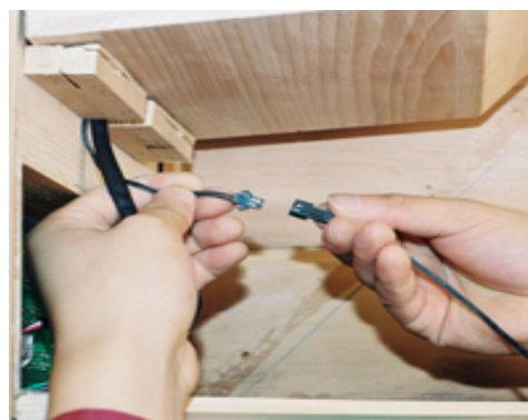
FIG-19 Ligue os fios do sensor
