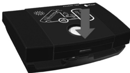
Fig. 13.1 Al doilea pas de închidere al carcasei
