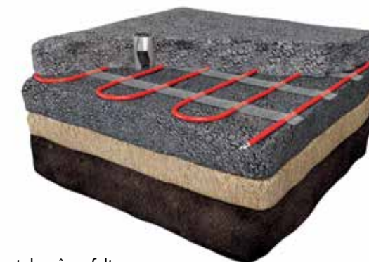
Instalare în asfalt
